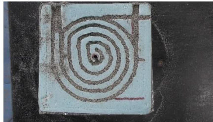
④模型 30 回転(砂進入口 3 箇所経路)_充填率 100%(成功)
