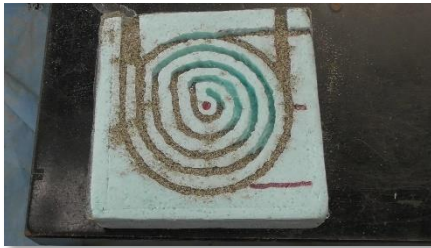
①模型 20 回転_充填率 50%(失敗)
