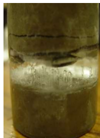
凍上試験後の岩石試料
