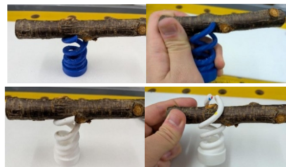
図6.枝の巻き込み実験 設計パラメータを反映する前のらせん(上) 設計パラメータを反映したらせん(下)
