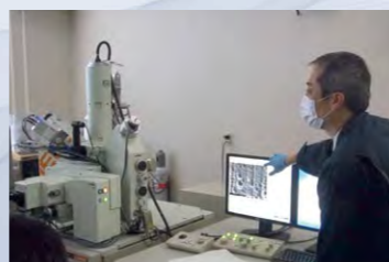
金属材料の組織を電子顕微鏡で観察しています！
