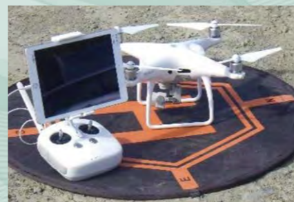
ドローンや光波を用いた地形測量(フィールドワーク)
