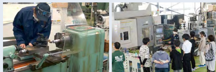
旋盤を操作し金属丸棒を切削中です！！
