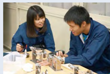
自分たちで制作したスターリングエンジンの性能実験中です！
