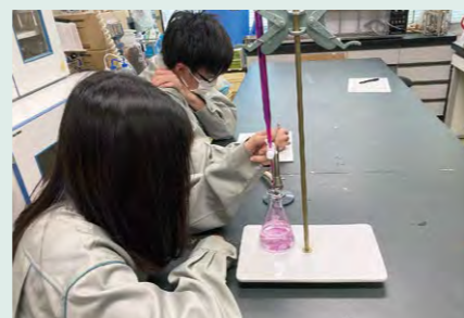
溶存酸素要求量の計測実験
