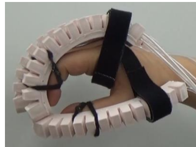
図2 指に取り付けたアクチュエータの外観
