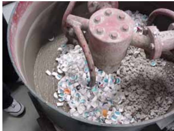
図3.6 コンクリート供試体作成状況
