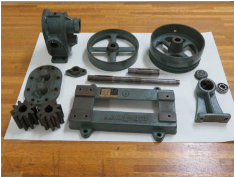
スケッチ製図する部品 (歯車ポンプ)
