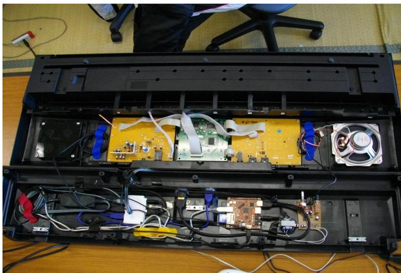
図5. 音楽教育用コンピュータの内部配置の様子
