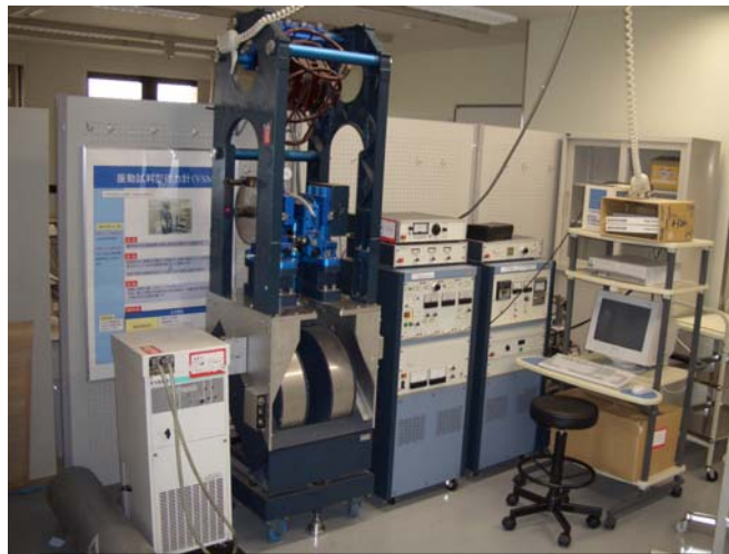
感度が非常に高い (0.002~100emu/F·S) たとえば粉末や膜などで、微量な試料も測定可能
