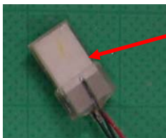
ベンダーエレメント (バイモルフ型振動子) (寸法: 1cm × 2cm 程度)
