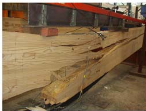
炭素繊維で補強した集成材の載荷実験
