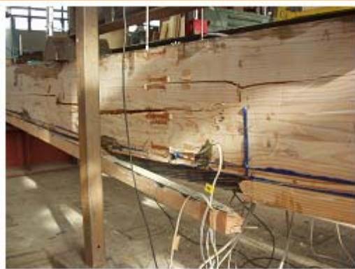
炭素繊維で補強した集成材の載荷実験
