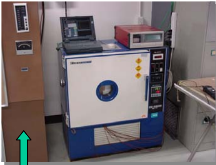
断熱温度上昇試験 コンクリートの発熱特性を正確に測定することができます
