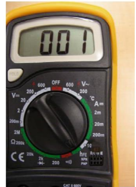
図. 破損している場合
